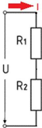
Der Strom ( $I$ ) wird durch den Gesamtwiderstand bestimmt und ist überall gleich groß.
