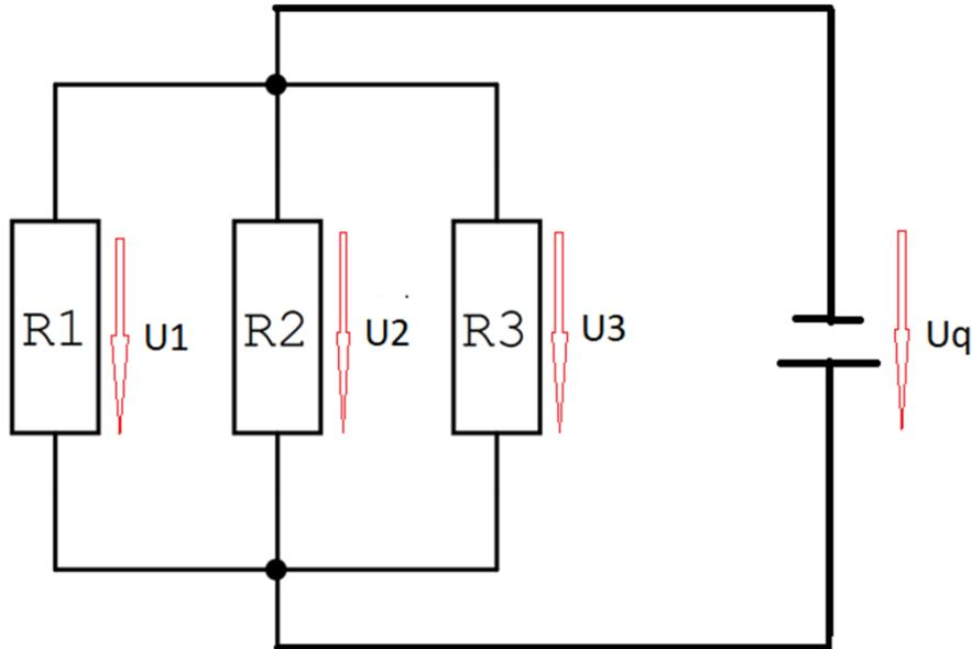
An allen **Widerständen** liegt die gleiche **Spannung** an wie an der **Spannungsquelle**:
