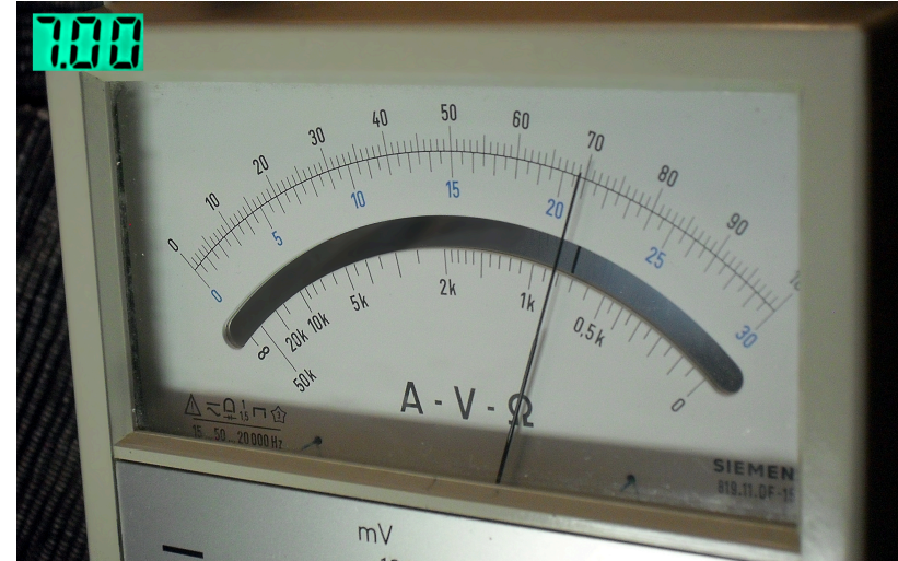
Abbildung 16: Zeigerinstrument mit Spiegel und Parallaxenfehler beim Ablesen
