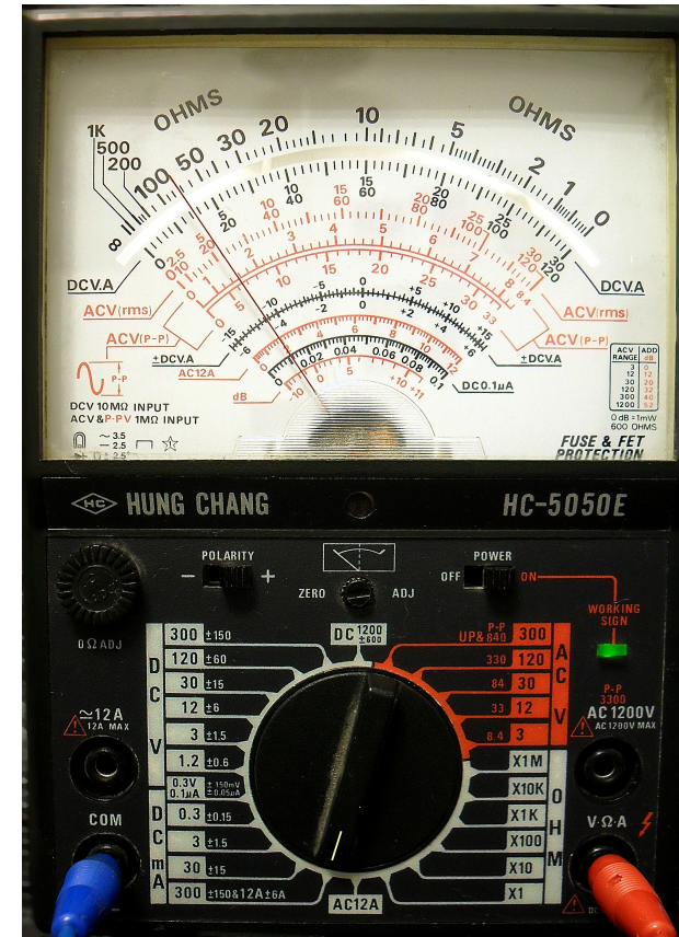
Abbildung 15: Zeigerinstrument mit mehreren Skalen
