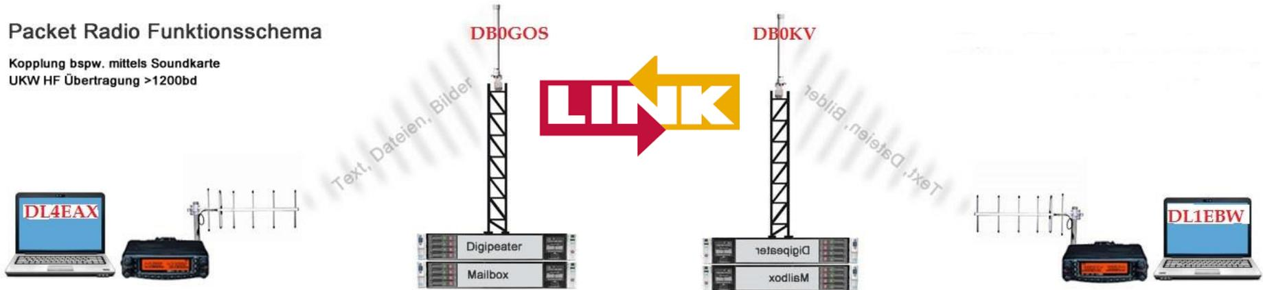
Eine Packet Radio Station besteht aus einem Computer mit einem **TNC** (Terminal **N**ode **C**ontroller). Das ist ein **Modem**, welches heute auch gerne als Software abgebildet wird. Dazu kommt ein 2m- oder 70cm-Funkgerät mit Antenne.
